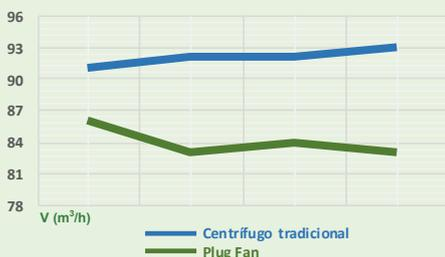
Menor nivel sonoro a igualdad de rendimiento aerodinámico con respecto a los ventiladores centrífugos tradicionales. Caudal optimizado a través del rodete.
